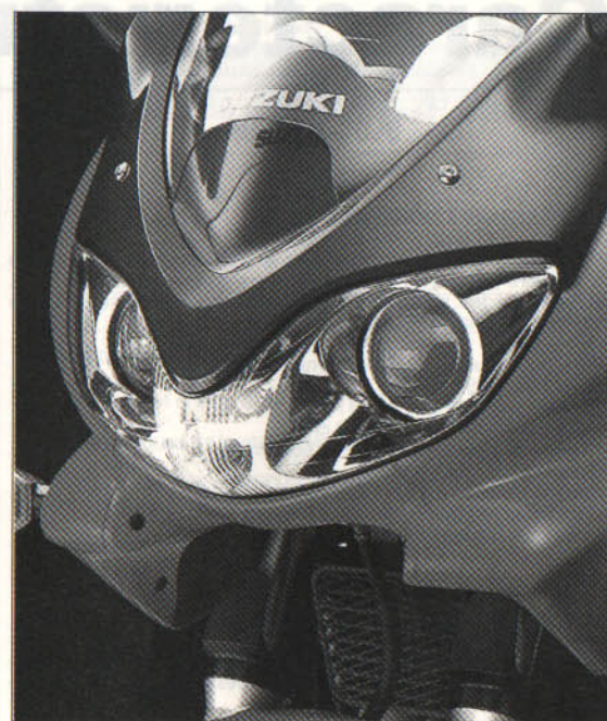
Δ Le modèle GSF 600 S dispose d'une double optique lenticulaire. La vitre de protection avant avec sa forme complexe surmontée dans habillage noir permet d'affirmer encore plus la silhouette de la machine
